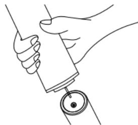
Ziehen Sie den Deckel der Nachfülldose ab und entfernen Sie den Adapterring mit den verschiedenen Aufsätzen. Der Adapterring ist für das Nachfüllen dieses Flambierbrenners in der Regel nicht notwendig. Falls die Spitze der Nachfülldose jedoch nicht in den Flambierbrenner passen sollte, wählen Sie bitte den entsprechenden Aufsatz aus dem
