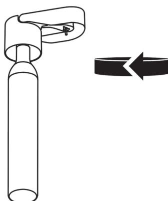
Fjern støvkorken fra CO<sub>2</sub>-flasken, og skru av flaskekoblingen fra kroppen. Hold flaskekoblingen i den ene hånden, og bruk den andre hånden til å skru CO<sub>2</sub>-flasken inn i flaskekoblingen med urviseren til den sitter fast.
