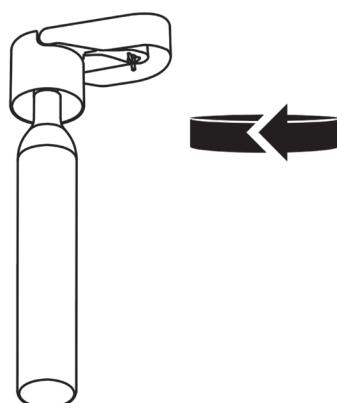
Ta bort det dammsäkra skyddet från kolsyreflaskan, skruva loss cylinderfästet från flaskan. Håll i cylinderfästet med ena handen medan du med den andra handen skruvar fast kolsyreflaskan moturs i cylinderfästet tills den sitter fast ordentligt.
