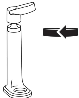
Placer cylinderfästet mitt för huvudenheten och vrid sedan medurs för att fästa cylinderfästet i huvudenheten.
