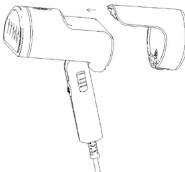
**Tømme:** Hold lokket og dra bakover. Åpne lokket i bunnen av beholderen, tøm ut vannet, lukk lokket igjen, og fyll beholderen.
