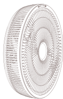
Gitter mit Ventilatorflügeln
