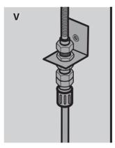
V) Beide Verschraubungen der Mehrfachverbindung (der Anschluss befindet sich an der rechten Seitenwand des Unterschranks)
