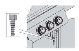
Im Lieferumfang ist bei 30 mbar Modellen ein Universaladapter enthalten, um den Gasschlauch vom Druckregler kommend mit dem Schlauch zum Brenner verbinden zu können.
